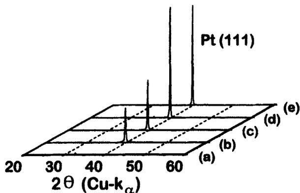
FIGURE 2 Variation of XRD patterns of Pt thin films deposited at (a)  $300^\circ\text{C}$ , (b)  $325^\circ\text{C}$ , (c)  $350^\circ\text{C}$ , (d)  $375^\circ\text{C}$  and (e)  $400^\circ\text{C}$ .
